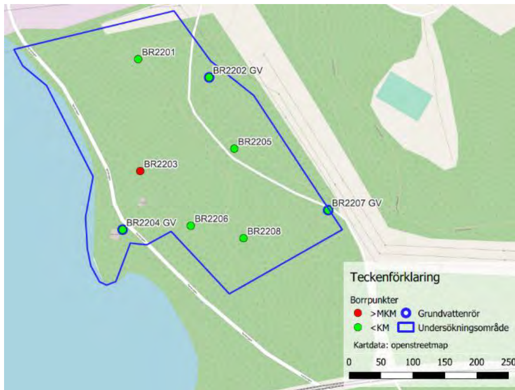
Figur 15 Provtagningspunkter inom översiktlig miljöteknisk markundersökning.
